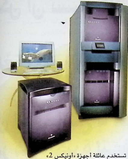
تستخدم عائلة أجهزة «أونيكس 2» هيكلية S2MP وأنظمة معالجة فرعية لتوفير أعلى أداء.
