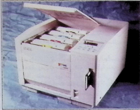
طابعة 4900 من «زيروكس»، وتظهر خراطيش صابغ الحبر الملون ومحرك أقراصها المرنة الداخلي.
