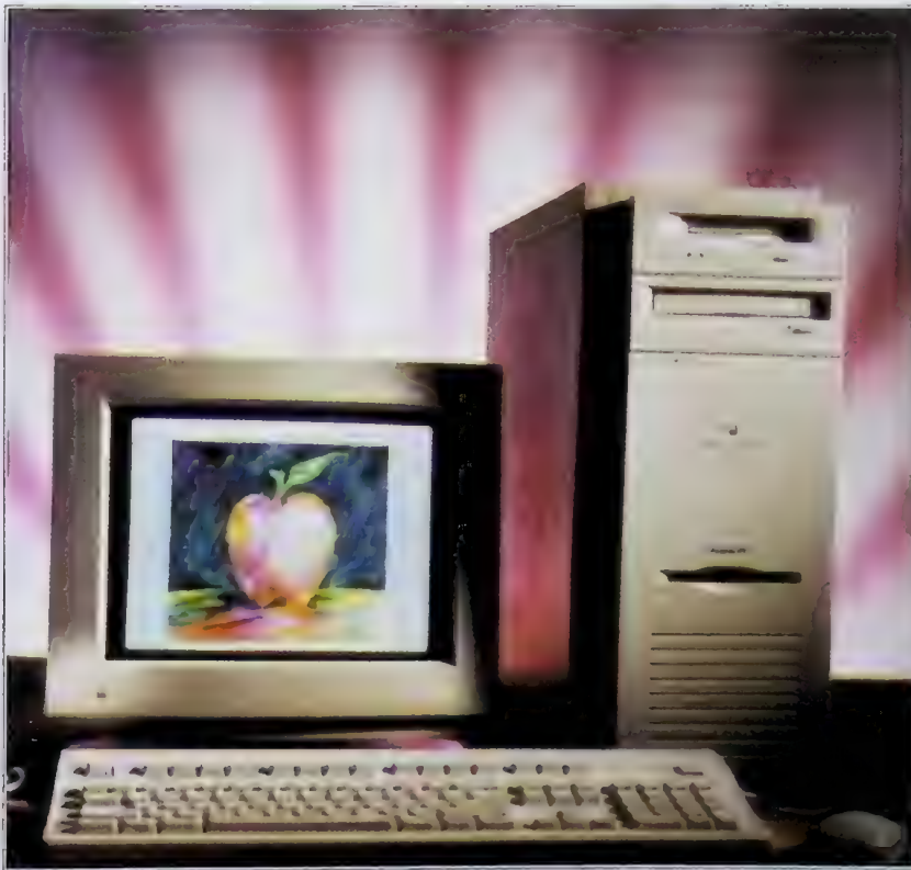
مزود خادم المجموعات 9150 فتحات أقراص تكني لخمسة محركات أقراص «سكزي» صلبة، ومحرك أقراص مدمجة ومحرك DAT. ويتيح لك ناقل «سكزي» وصل سبعة أقراص صلبة خارج البرج.
